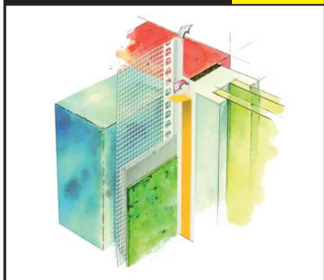
Profilo intradosso finestra in PVC con rete "standard" per intonaco 6 mm.
